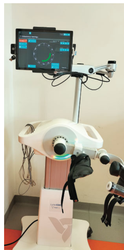
Urządzenie do wczesnej rehabilitacji neurologicznej kończyn górnych i kończyn dolnych z biofeedback
