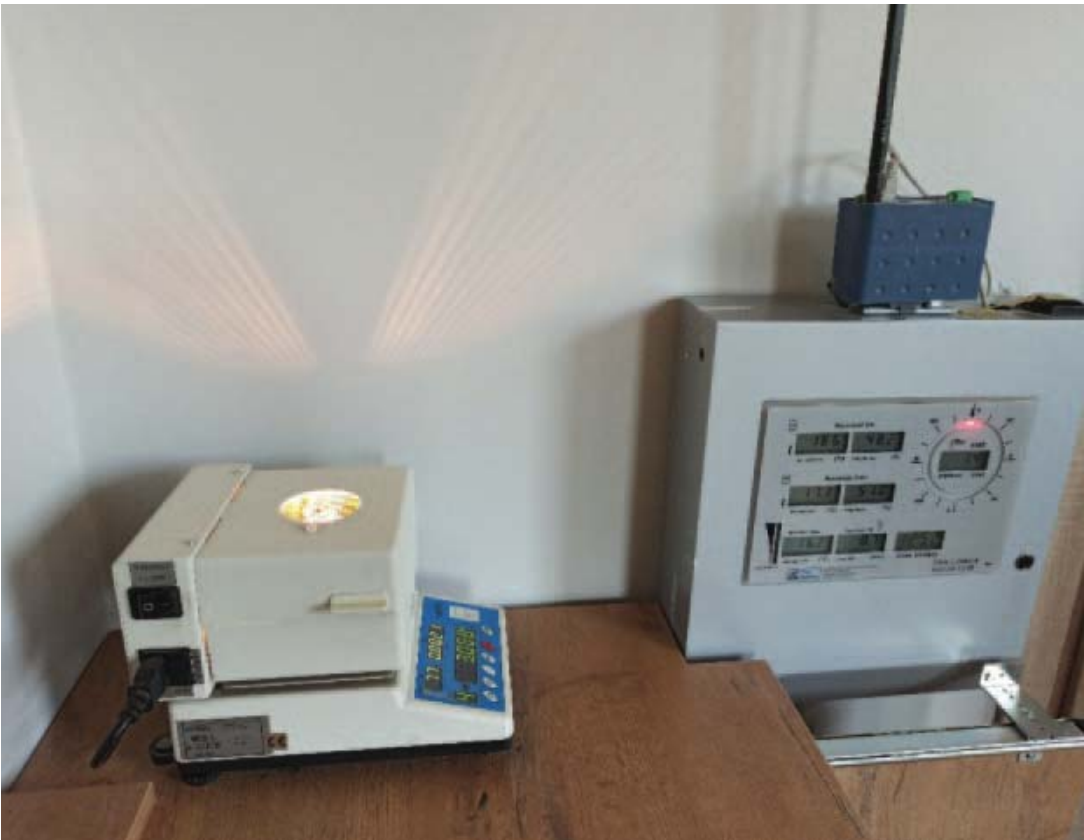
Pracująca wagosuszarka i umieszczony obok rejestrator danych pomiarowych
