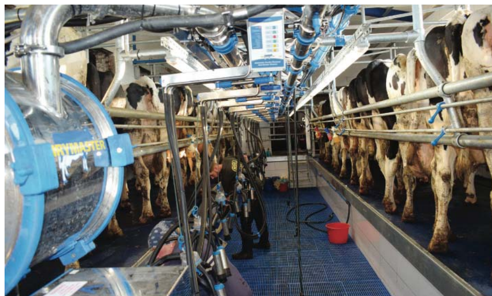
Dairymaster doi pod wysokim podciśnieniem 50 kPa w czasie całego doju i maksymalnie odpuszcza, czyli zmniejsza podciśnienie do 5 kPa w fazie odpoczynku
