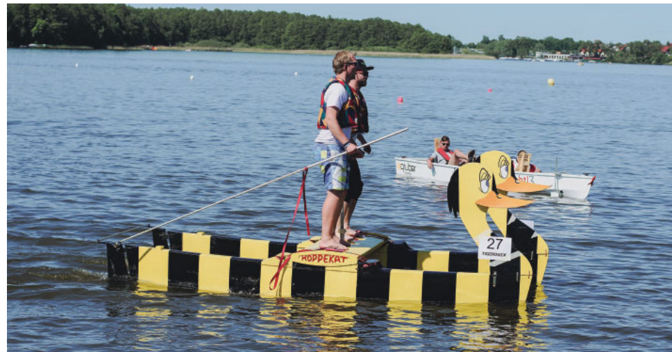
Ta specyficzna konstrukcja przyjechała nad Jeziorak z Holandii. Dwukadłubowy pojazd napędzany jest przez dwie osoby poprzez pionowy balans ciała
