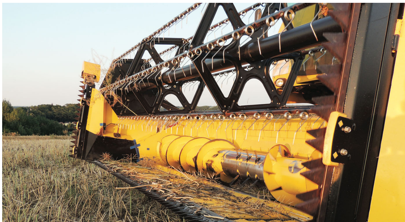
Zespół żniwny kombajnu przygotowany do zbioru rzepaku — wydłużona podłoga oraz aktywne rozdzielacze łanu Fot. Marcin Jarocki
