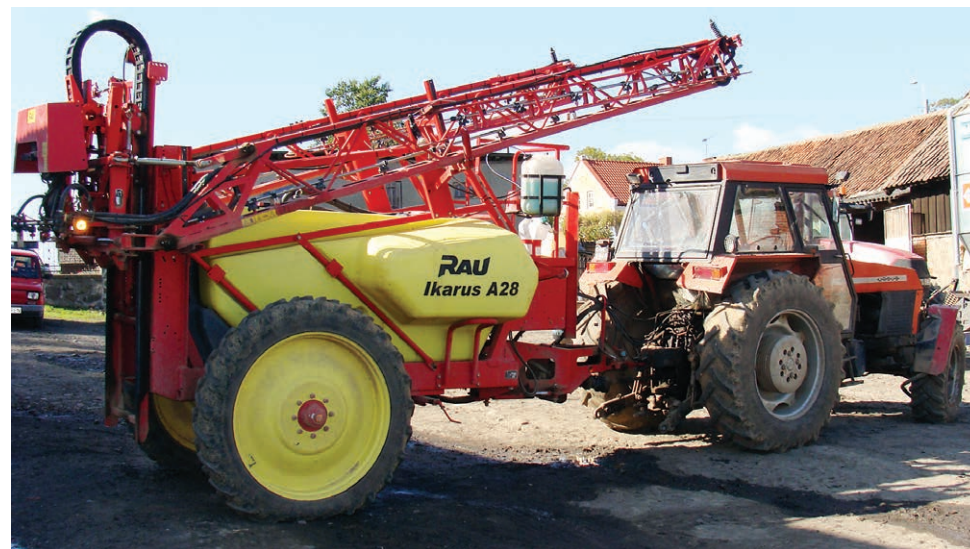
W technologii nawożenia roztworem saletrano-mocznikowym używa się opryskiwaczy, w których wszystkie elementy robocze są odporne na korozję Fot. Anna Uranowska
