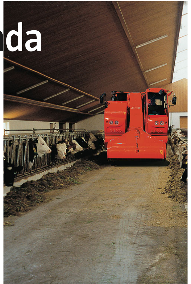
Wóz paszowy dobieramy do wielkości stada i ilości skarmianej paszy. Przykładowo te do 15 m 3 z jednym pionowym ślimakiem, mogą być z powodzeniem wykorzystane przez hodowców mających do 100 krów. Fot. PHU Perkoz
