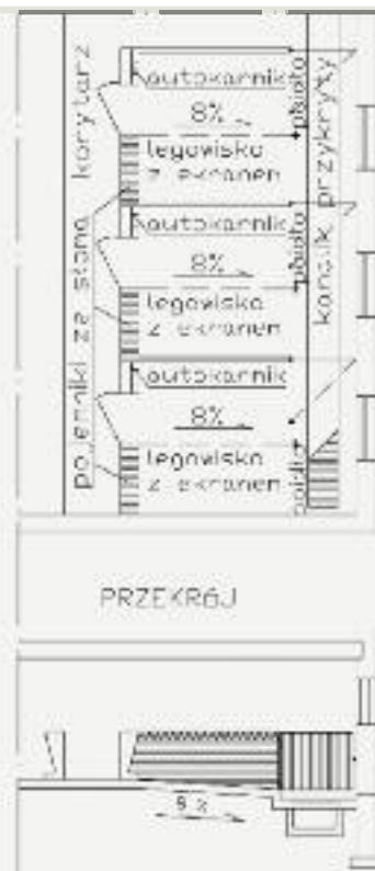
Rys. 2. Kojce z posadzkami samospławialnymi. Zaletą tego rozwiązania jest wykorzystanie zwierząt do ścielenia części legowiskowej kojca oraz do nagarniania odchodów na część gnojową Autor Jan Lewarowski, graf. Anna Uranowska
