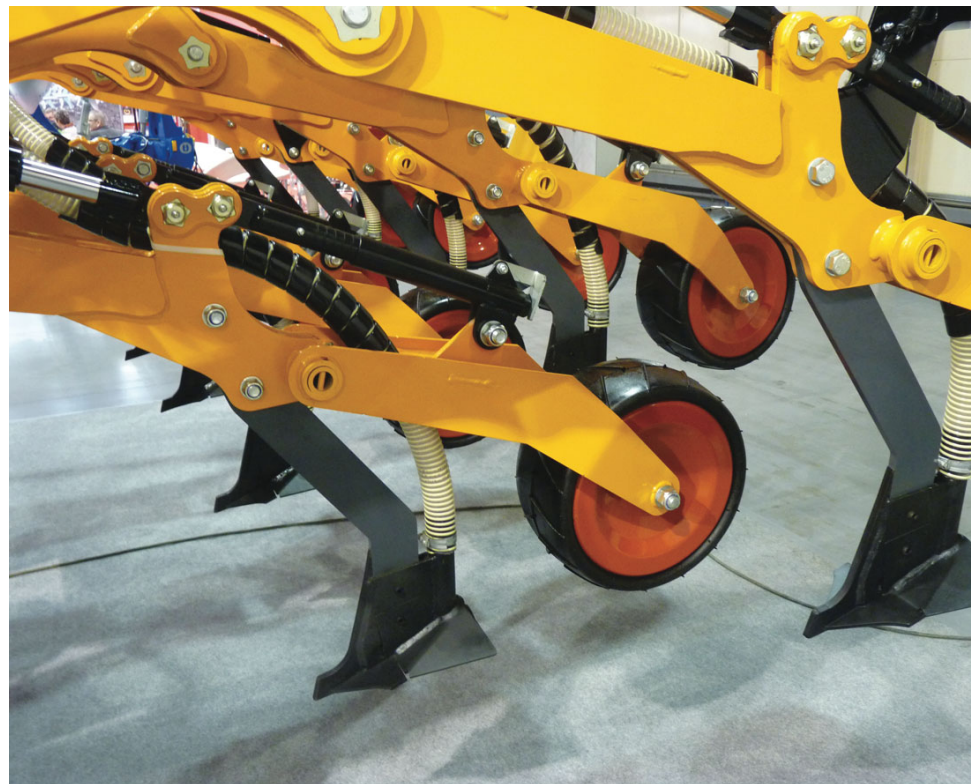
Redlica gęsiostopkowa rozsiewająca nasiona na szerokość kilkunastu centymetrów i tworząca wysianą taśmę w uprawionym pasie Fot. Tomasz Piechota
