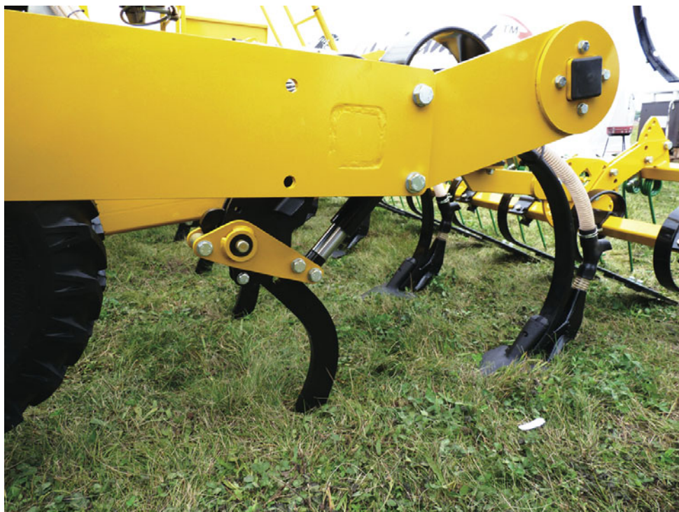
Agregat o uproszczonej budowie ograniczonej do zęba wznoszącego glebę, redlicy siewnika i elementu zagarniającego Fot. Tomasz Piechota
