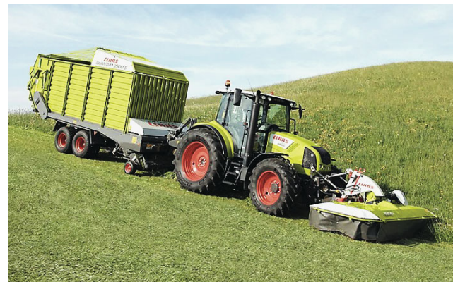
Kardanowe zawieszenie rotorów idealnie dopasowuje maszynę do nierówności pola Fot. Claas
